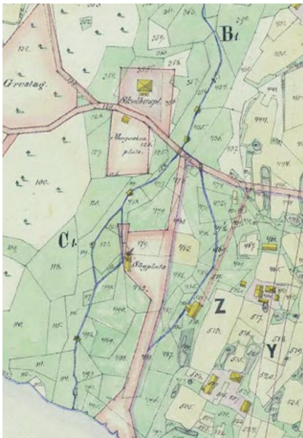
Figur 81. Utsnitt ur karta över storskifte i Kittans by i Älvdalen, Dalarna 1871. Flera kanaler har grävts för att leda bäcken norrifrån genom ängarna innan den når Nässjön. I kanalerna finns flera vattendrivna skvaltkvarnar, en såg och två tröskor. Levander 1943, s. 206. Karta Lantmäterimyndighetens arkiv U61-12:1 (PDM).
